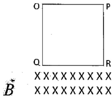
**Datos:** lado,  $L = 2 \text{ cm}$ , sección,  $S = 1,5 \text{ mm}^2$ , inducción magnética,  $B = 2 \text{ T}$ , resistividad del conductor  $\rho = 1,5 \cdot 10^{-6} \Omega \cdot \text{m}$ , densidad del hilo,  $d = 8,7 \text{ g} \cdot \text{cm}^{-3}$  y gravedad,  $g = 9,8 \text{ m} \cdot \text{s}^{-2}$
